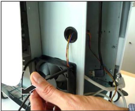
2. Hold the new fan over the fan opening.
